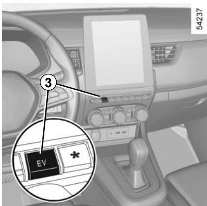
Når hybridsystemet bruker forbrenningsmotoren med eller uten den elektriske motoren til å drive kjøretøybevegelsen, er det mulig å skifte til helelektrisk modus manuelt.
