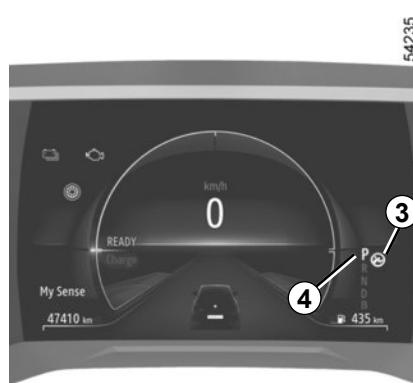
4-indikatoren i instrumentpanelet viser aktuell girspakstilling 1.
