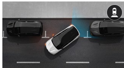
Peruutuskamera. Kameran kuva näytetään kojelaudan näytöllä, kun kytket peruutusvaihteen. Kuvan päällä näytettävät ajolinjoja hahmottavat viivat helpottavat peruuttamista ja tekevät siitä turvallisempaa.
