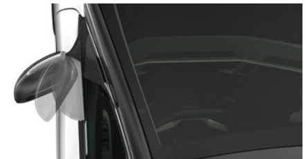
Taittuvat ovipeilit muistilla. Peilit taittuvat automaattisesti auton kylkien suuntaiseksi ja nousevat lähtiessä taas käyttöasentoon muistaen omat asetukset. Peruutettaessa oikeat taustapeili kääntyy osoittamaan alaviistoon.
