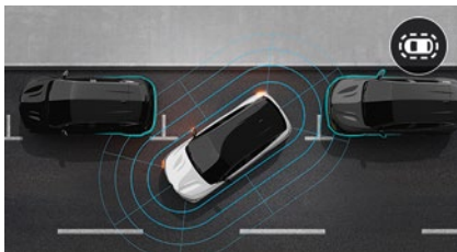
360 asteen 3D-kamerajärjestelmä. Neljä kameraa tuottaa 360 asteen näkymän autosi ympärille, jotta pysäköinti käy helposti ja sujuvasti.
