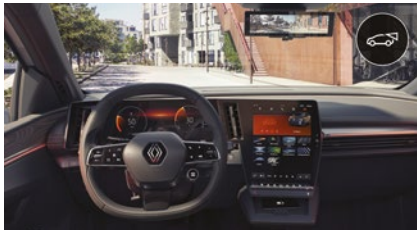
Älykäs taustapeilikamera. Järjestelmä välittää takalasiin sijoitetun kameran avulla näkymän taaksepäin.
