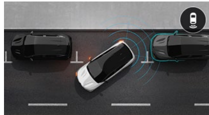
Pysäköintitunnistimet takana. Tutkan sensorit auttavat sinua pysäköimään autosi. Saat ääni- ja valomerkeillä varoitukset auton takana lähellä olevista esteistä.
