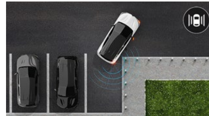
Pysäköintitunnistimet sivuilla. Sensorit auttavat pysäköinnissä antamalla ääni- ja valomerkit, jos auton lähellä sivuilla on esteitä.
