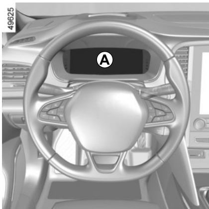
Kojetaulu A: Tämä syttyy, kun kuljettajan ovi avataan.
